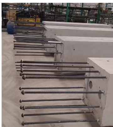
图 3.4.3 预制柱脱模养护
