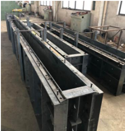
图 3.5.1 预制梁模具制作
