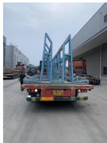
图 3.6.4 飘窗运输堆放架
