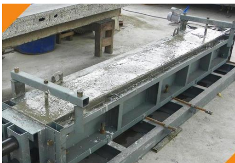
图 3.4.2 预制柱混凝土浇筑
