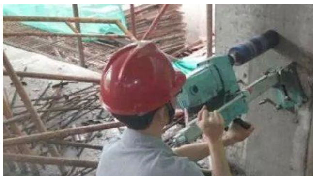
图 4.4.28 钻芯检测法
