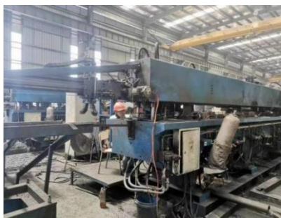
图 3.2.1 桁架筋自动生产加工
