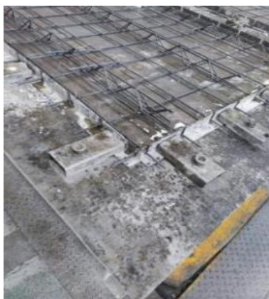
图 3.2.3 带磁铁的固定装置
