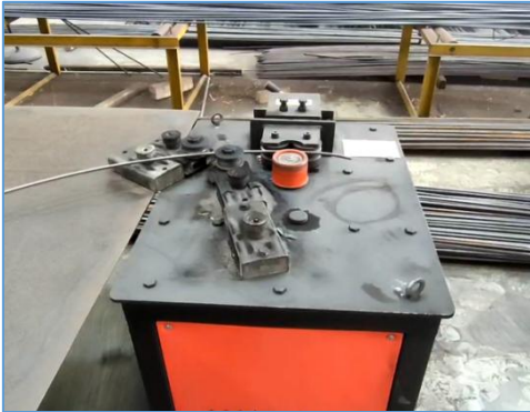
图 6.5.25 弧形钢筋弯制
