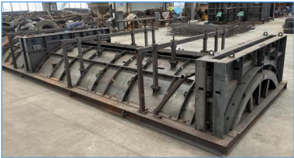
图 6.5.23 模具底座及端板实体展示
