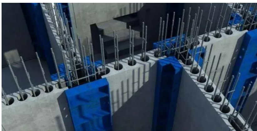
图 2.2.10 EVE 装配式空心板叠合剪力墙结构体系示意图
