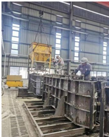
图 3.1.3 混凝土浇筑振捣
