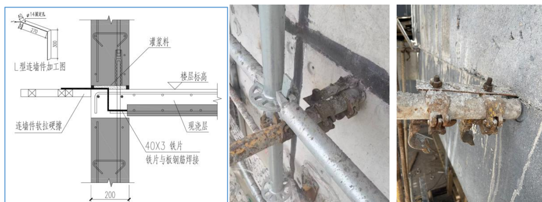
图 5.1.5 预埋 L 型铁片连墙件做法（PC 墙）
