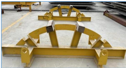
图 6.5.31 弧形板运输支架（含方木）
