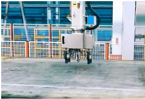
图 3.7.3 拆布模机械手
