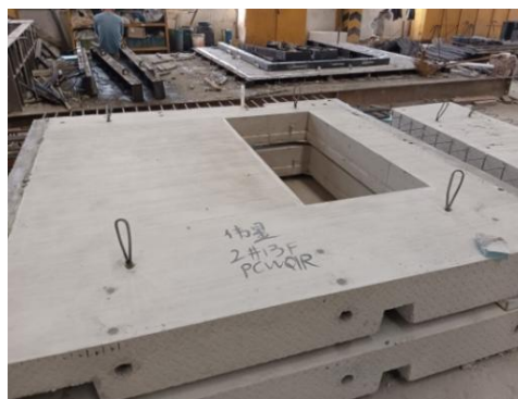
图 3.3.9 预制墙体构件起吊点
