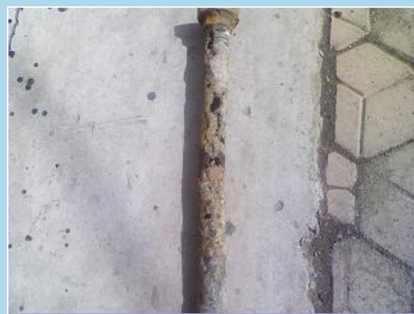
腐蚀严重的镀锌钢管
