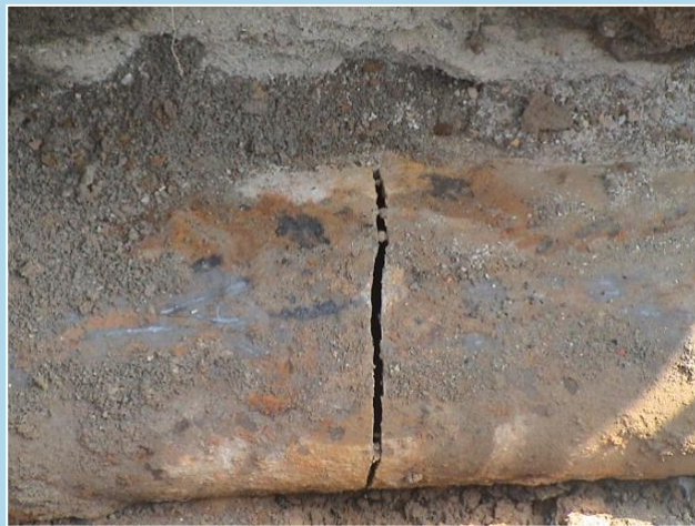
断裂的灰口铸铁管
