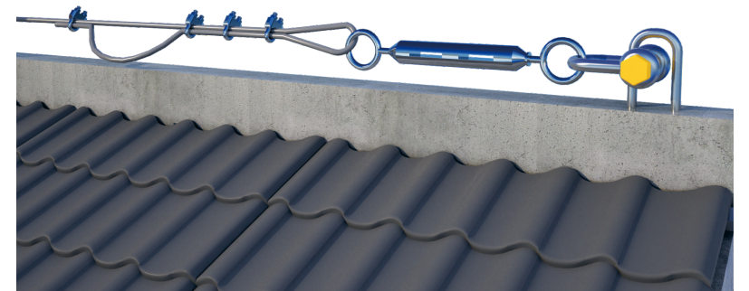
图3.9.2 水平生命线端部固定细节图
