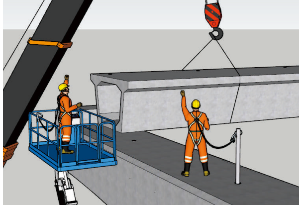
图3.10.1 箱梁作业人员安全带系挂效果图
