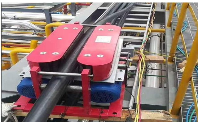
图 6.9.1 履带式电缆输送机应用
