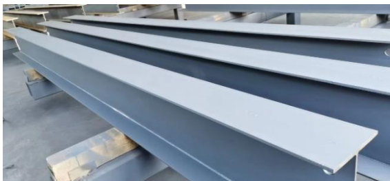
图 5.7.5 水性无机防腐涂料施工
