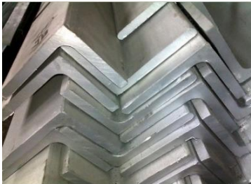
图 5.7.4 热浸镀锌防腐施工
