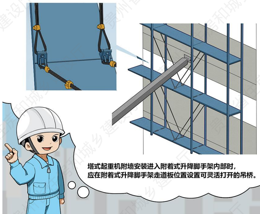
塔式起重机附墙进入脚手架时吊桥设置
