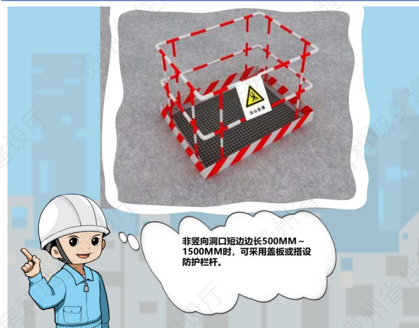
短边边长 500mm ~ 1500mm 洞口防护
