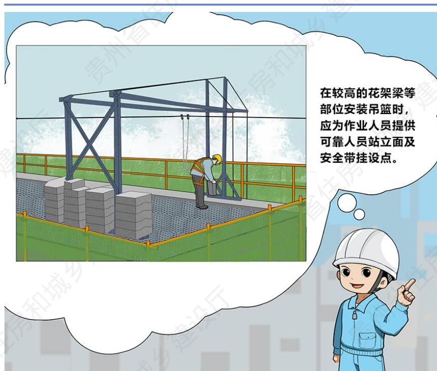
无可靠站立面的位置吊篮安装安全措施
