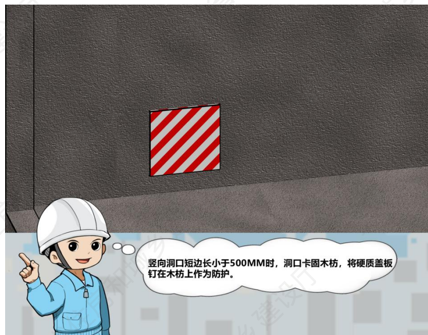
短边长小于 500mm 竖向洞口防护
