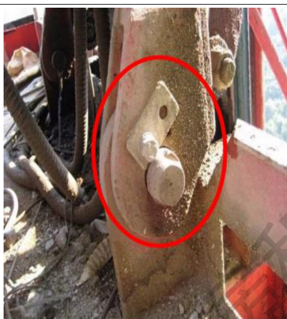
隐患：止退板螺栓缺失
