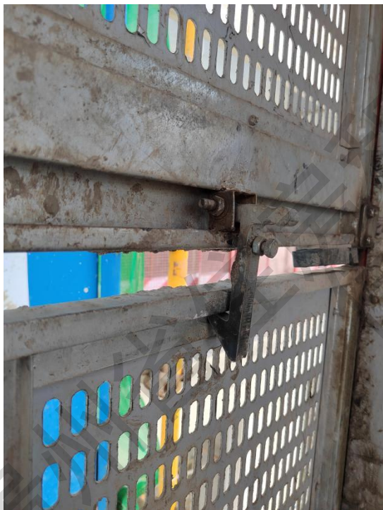
正确示例：吊笼门机械锁紧装置完好、规范安装
