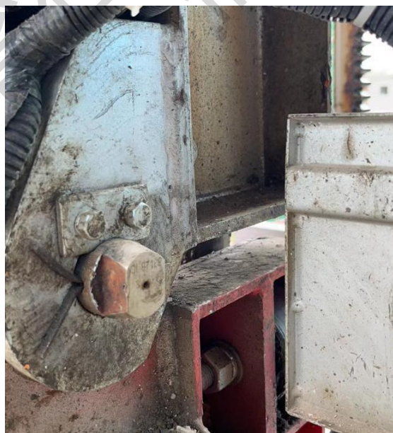
正确示例：传动小车销轴规范安装
