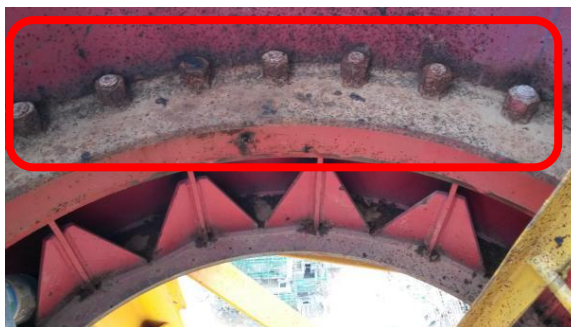
回转部位隐患：螺丝严重锈蚀
