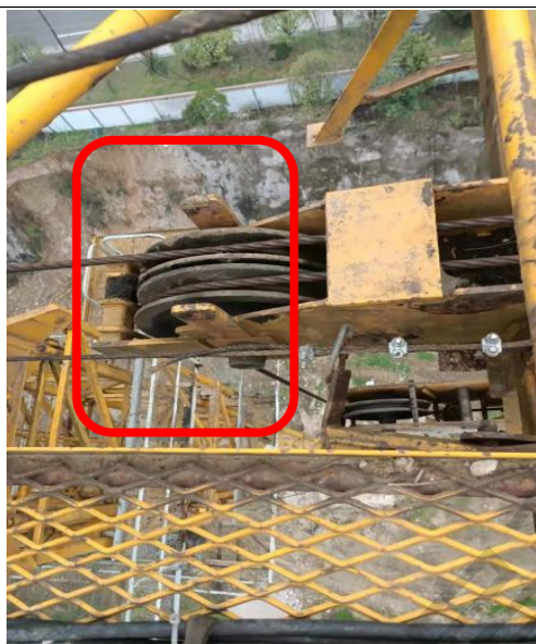
隐患：钢丝绳防脱装置缺失
