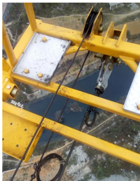
正确示例：钢丝绳完好、无缺陷
