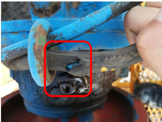
隐患：电缆线破损
