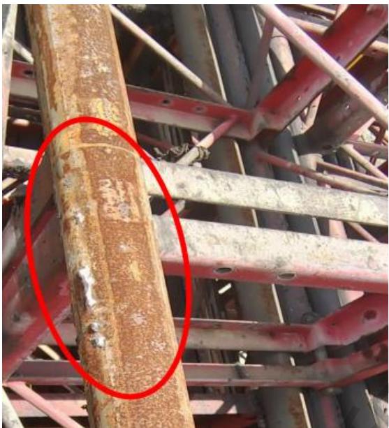
隐患：标准节结构锈蚀严重
