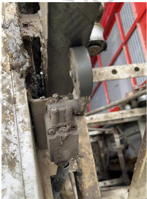
正确示例：防冲顶限位正确安装
