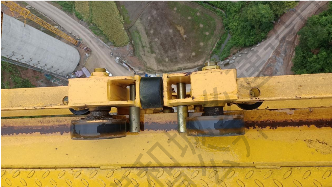
正确示例：断轴保护装置完好
