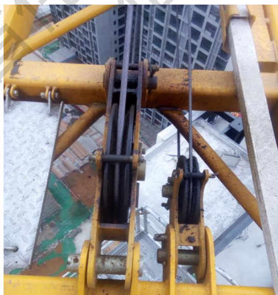
正确示例：钢丝绳防脱装置安装正确、齐全
