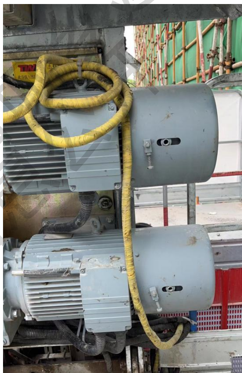
正确示例：制动器灵敏有效
