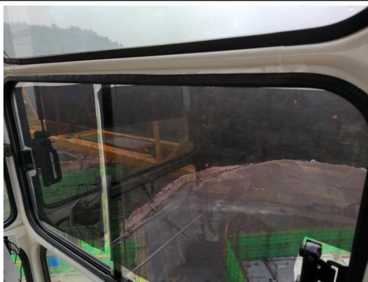
正确示例：驾驶室视线良好、无遮挡
