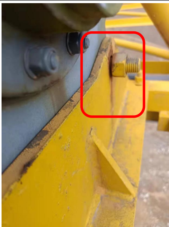
变幅机构部位隐患：固定螺栓松动
