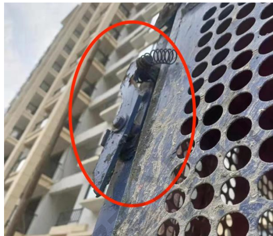
隐患：围栏门机械锁紧装置失效
