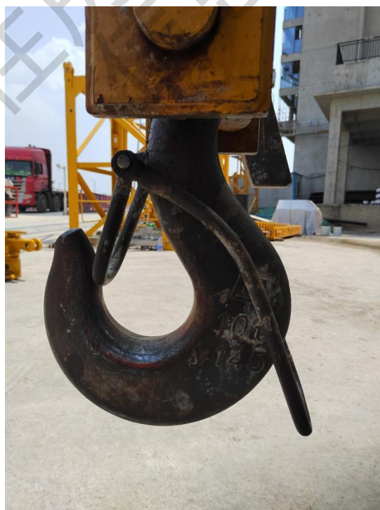
正确示例：防脱钩装置完好，与吊钩紧密贴合
