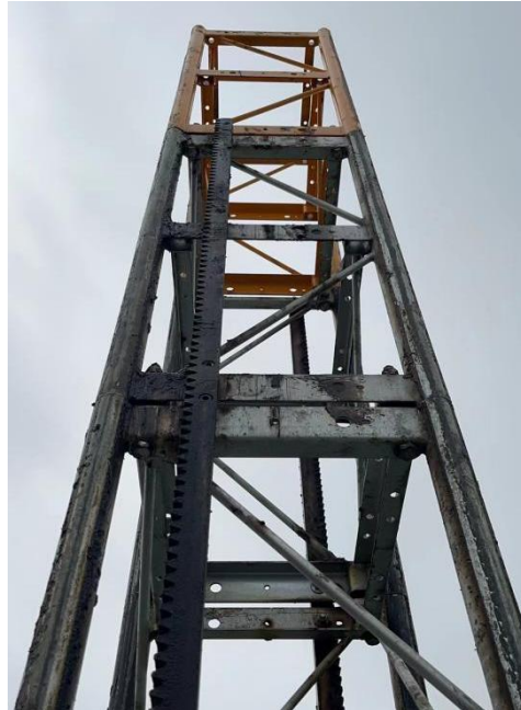
正确示例：正确安装无齿节
