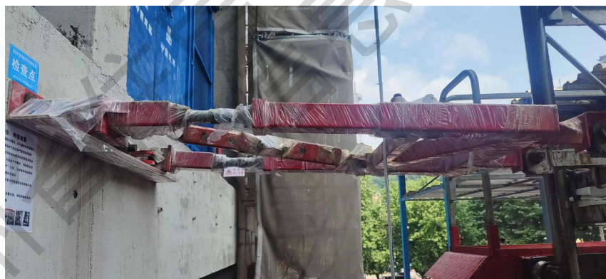
隐患：附墙架严重锈蚀，腹杆开裂
