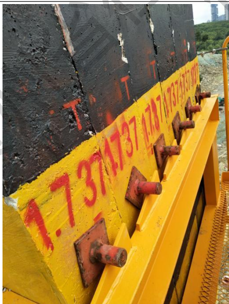
正确示例：配重完好，安装规范
