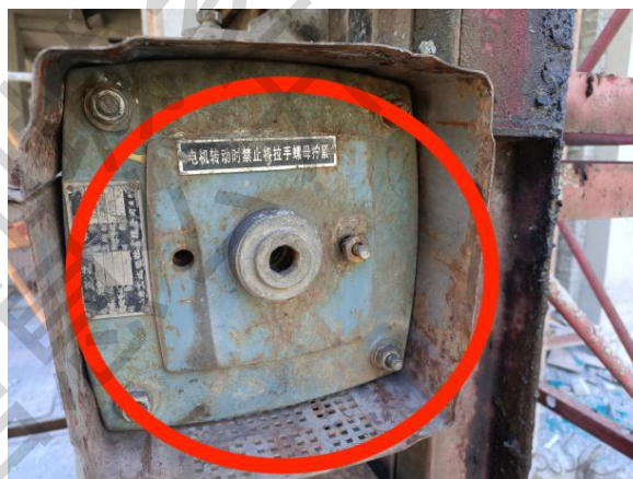
隐患：制动器手动释放装置失效
