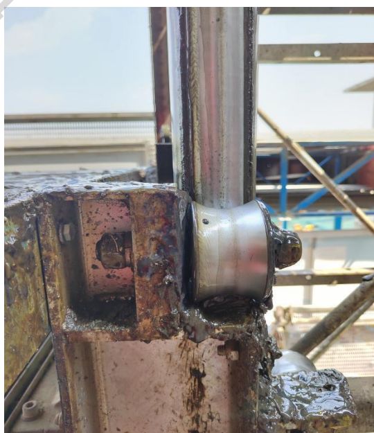
正确示例：导向滚轮规范安装
