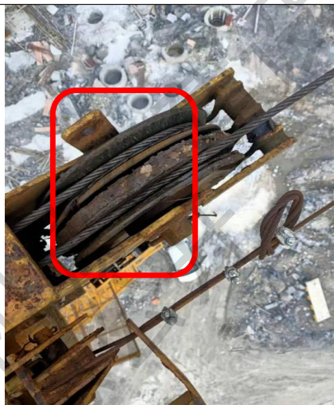
隐患：钢丝绳防脱装置缺失
