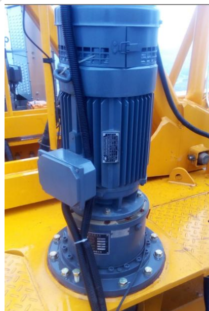
正确示例：回转电机规范安装
