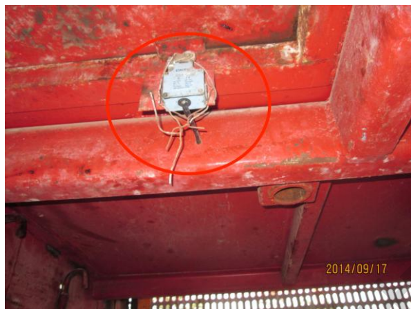
隐患：吊笼顶窗电气安全开关失效
