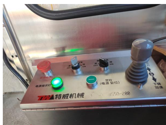
正确示例：操纵系统各部件完好，各项功能齐全、有效
