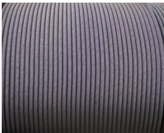
正确示例：钢丝绳完好、无缺陷
