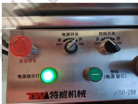
正确示例：操纵系统各部件完好，各项功能齐全、有效
