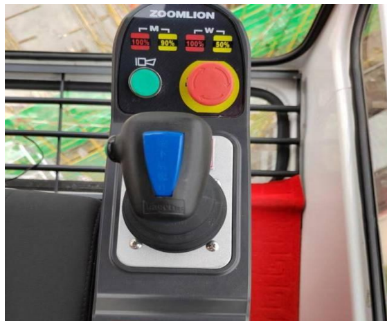
正确示例：操纵系统完好，各项功能齐全、有效
