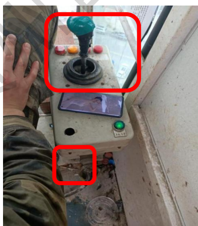
隐患：误操作保护装置失效、警报电铃缺失、防尘罩损坏
