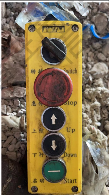
正确示例：控制盒完好、方向标识清晰
