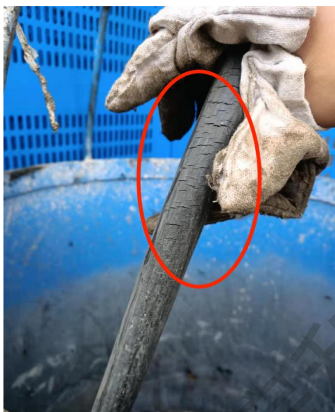
隐患：电缆线老化、破损
