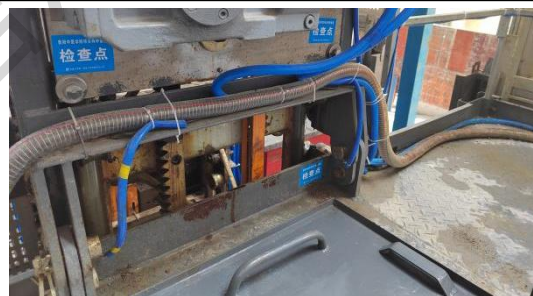
正确示例：超载保护器规范安装
