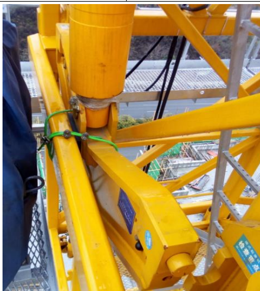
正确示例：顶升油缸非自由悬挂、液压系统无漏油现象
