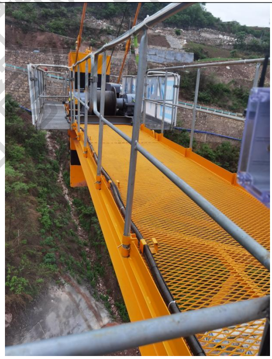
正确示例：平衡臂护栏规范安装
