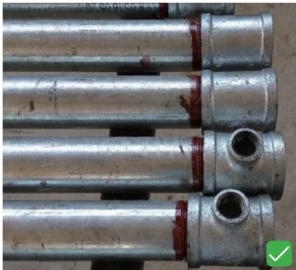
1. 拧紧后螺纹外露1~3丝，并进行防锈处理。
