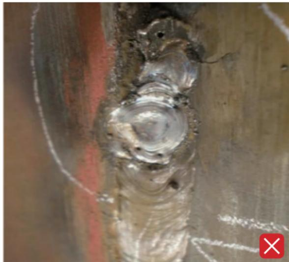
焊缝有气孔、夹渣等表面缺陷。
