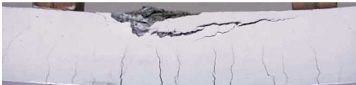
出现超过梁高 2/3 的竖向裂缝
