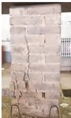
砖柱出现竖向裂缝
