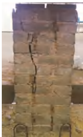
砖柱出现竖向裂缝
